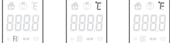
Tartsa nyomva 3 mp-ig és az F1 ikon megjelenik / Press and hold for 3 seconds, F1 will flash Kijelző alapbeállítás: 0°C / Screen default display: 0°C Nyomja meg a Memória "+" vagy Memória "-" gombot az átváltáshoz / Press Memory "+" or Memory "-" to switch
